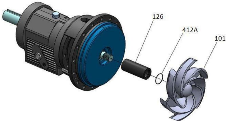
**Figura 52: Instalación de la manga de la flecha**
